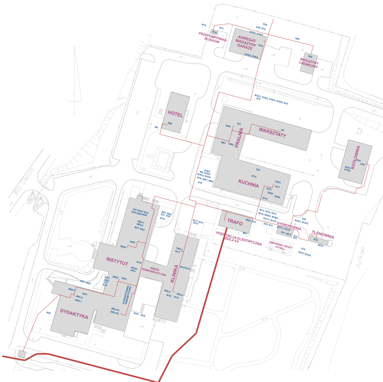
Rysunek 1.5 Układ rozprawdzeń kablowych na niskim napięciu ze stacji głównej do rozdzielni budynkowych wraz z przebiegiem linii zasilających średniego napięcia (przebieg oznaczono pogrubioną czerwoną linią)
